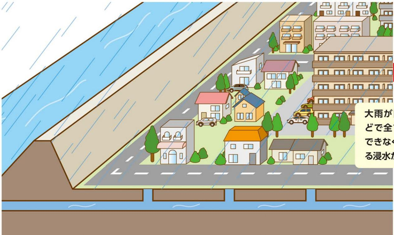
宅地に降った雨は雨水ますへ、道路に降った雨は道路側溝などに集まり、下水道や水路等を通じて河川に排水されます。
