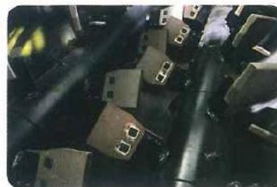
原料と添加剤の混合と搬送を同時に行う連続式です。シャフトに取り付けられたパドルが、原料を掻き合わせるように動くため、原料と添加剤の混合・混練・造粒に優れたミキサーです。
