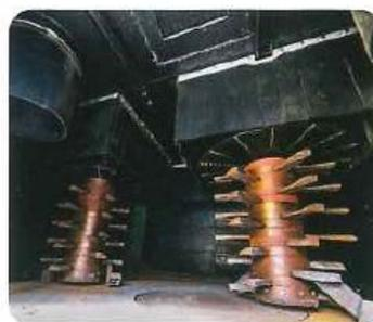
革新的なミキシング技術を持つアイリッヒミキサーは、回転する混合パン(釜)が連続的かつ効率よく、原料を内部にある2本の混合工具へ移動させることにより、原料の均質化・短時間処理を行い品質を高安定化することができる特殊なミキサーです。
