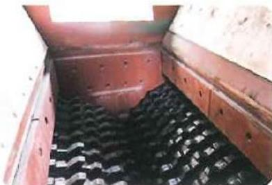
廃棄物と添加剤などの粉末原料を、回転する2本のロール間に通すことにより、原料中の粘土塊をほぐしながら、同時に添加剤などを確実に練り込むことができます。また、圧縮・粒度調整を行います。
