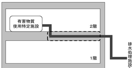
点線で囲われた部分は床下にもぐっていますが、下部階から有害物質を含む水の漏えいが目視により容易に確認できるよう設置されることから、**地上配管として扱うことが可能です。**
