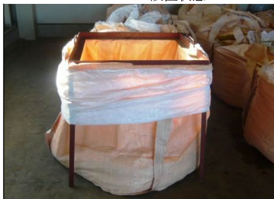
■ フレームのフレコン設置状態
