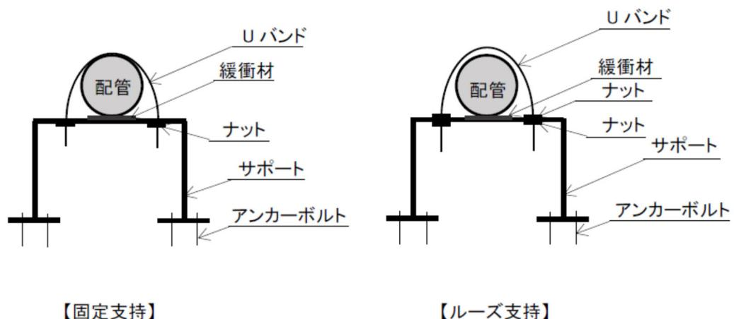
直線部の支持方法：両端に固定支持、配管途中にルーズ支持を設け伸縮吸収する
