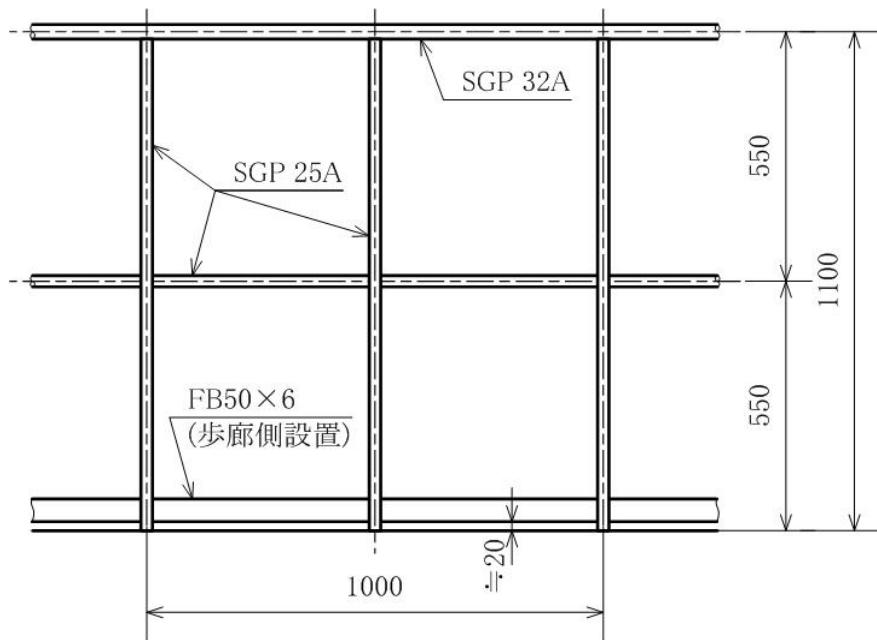
ウ 池まわり用アルミ手摺りは、日本下水道事業団「土木施設標準図(詳細)土木・建築・建築設備編(平成12年版)」による。
