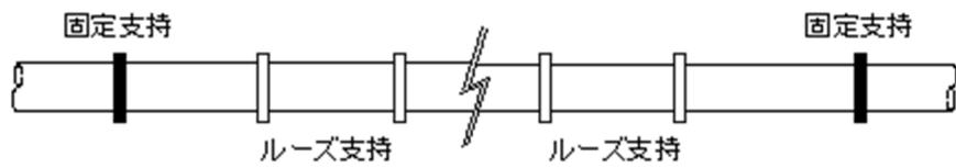
曲がり部の支持方法：曲がり部から離れた位置に固定支持、配管途中にルーズ支持を設け伸縮吸収する
