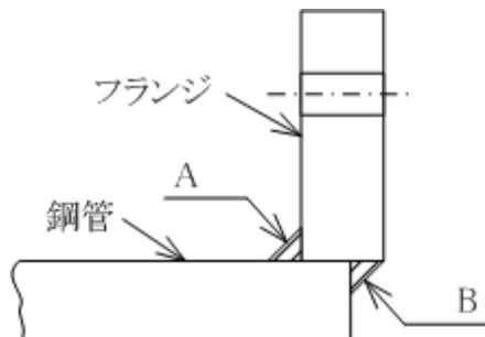
(3) 突合わせ溶接等を行った場合、非破壊検査後に内面、外面の塗装等を行うこと。（「2-2-2機器等の設計製作、加工」第5項参照）
