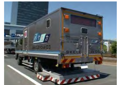
空洞探査車による調査
