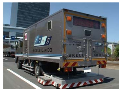
空洞探査車による調査
