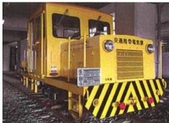
工事用モーターカー (1998年製)
