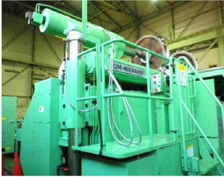
新羽車両基地 車輪転削盤
