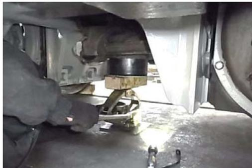
抜けたブッシュをジャッキを使用し手挿入 作業画像
