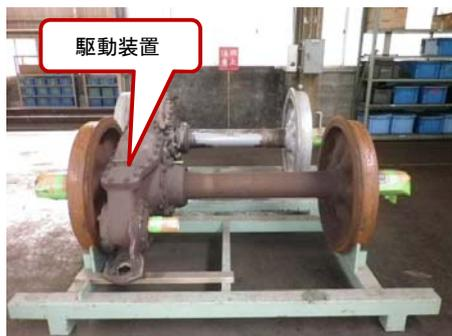
M車輪軸(駆動装置付き)
