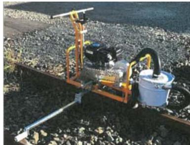
手押し式レール削正機
