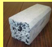
スラグを利用したコンクリート 2 次製品 (敷地境界ブロック) 試作品
