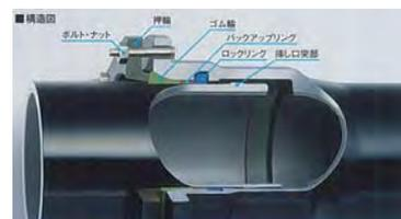
耐震継手(拔出し防止機能)の構造
