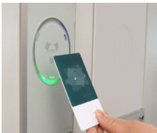
ICカード認証による電子錠の施解錠イメージ
