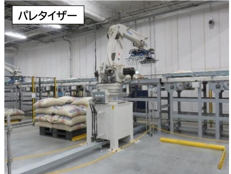
【重量センサー等のデジタル技術の導入により、パレットの上に均一の荷姿で貨物を集積する設備(パレタイザー)の状況】
