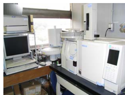
ヘッドスペースーガスクロマトグラフ質量分析計
