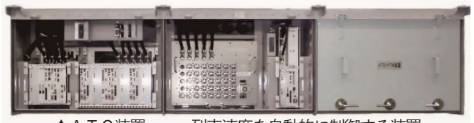
▲ A T C 装置・・・列車速度を自動的に制御する装置
