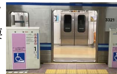
段差・隙間縮小
