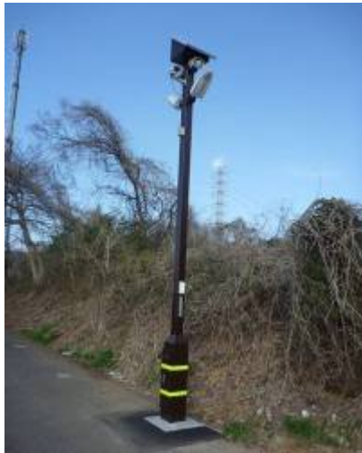
【写真】 不法投棄監視警報装置の例(都筑区)
