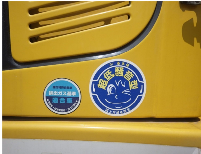
写真 2. 4. 4-4 環境保全のための措置の実施状況（環境対策型建設機械の使用）
