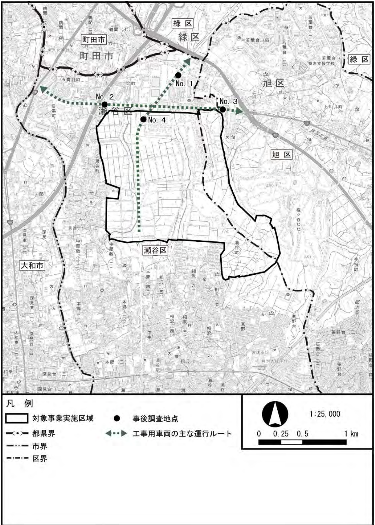
図 4.3-1 工事用車両の運行による騒音事後調査地点
