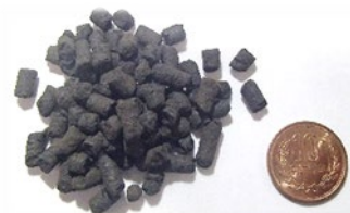
下水汚泥の燃料化物
