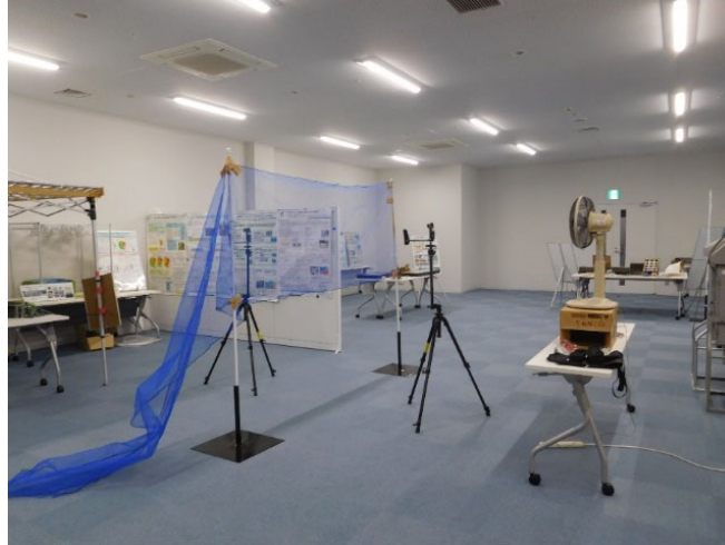
図 5-2-7 防風ネットを用いた風速の減衰率の実験の様子
