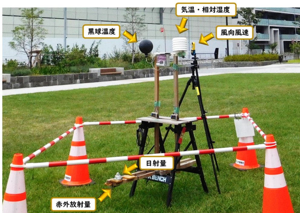
図 4-1-1 環境科学研究所で使用した観測機器の設置状況 (5.1 章での観測より)
