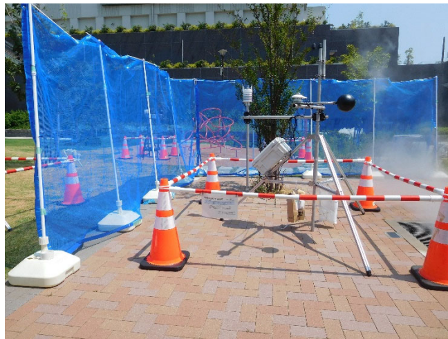
図 5-2-3 実測調査時の仕切り(防風ネット)の設置状況の様子
