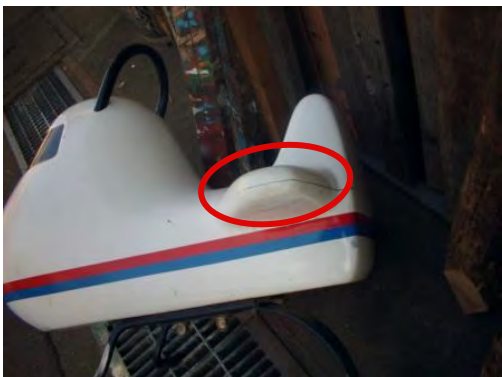
▲ 本体の亀裂（FRP製）
