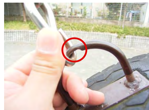
▲ タイヤ取付リングの摩耗
