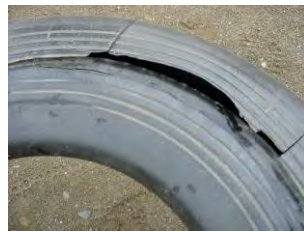
ゴム系素材の劣化状
