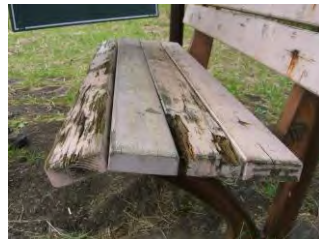
腐朽の中期段階
