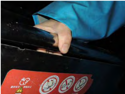
▲ ブランコ側板の溶接部破損
