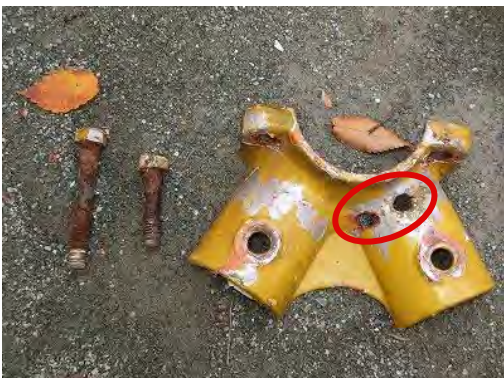
▲ ブランコ支柱継ぎ手金具（鋳物）の穴
