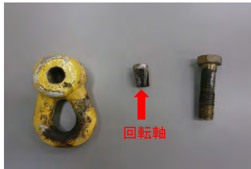
▲ 回転軸の破損
