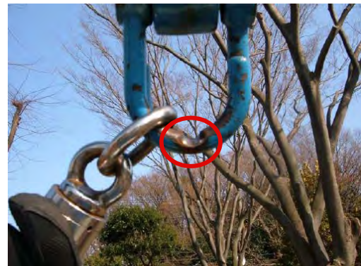
▲ 上部吊金具摩耗
