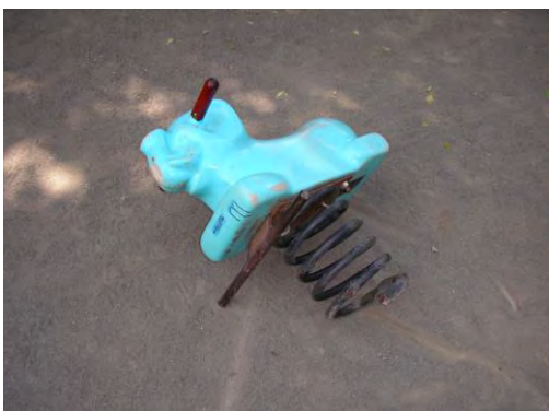
▲ スプリングの破損
