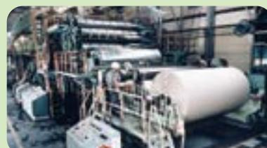
紙すき、脱水、乾燥工程後、ロール状に巻き上げます。
