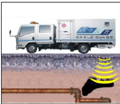
<空洞探査車調査イメージ>
