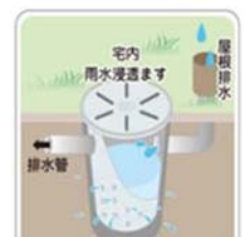
宅内雨水浸透ます
