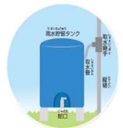
雨水貯留タンク
