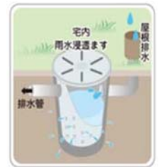
住宅内雨水浸透ます
