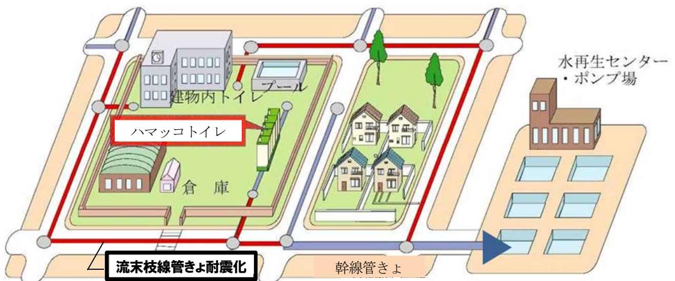
地域防災拠点等につながる流末枝線管きよ(赤線で表示)の模式図
