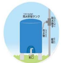
雨水貯留タンク
