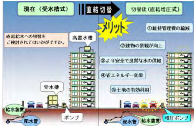
直結給水への切り替え（イメージ）
