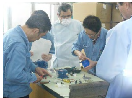
水道メーター分解作業
