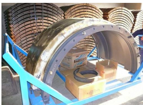
写真 相模原ポンプ場に保管している大口径管カバージョイント
