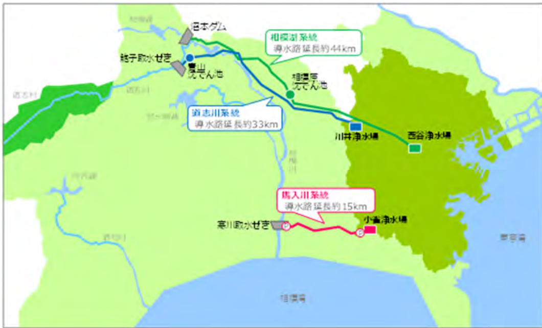
図1 本市の取水・導水施設概要図
