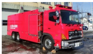
移動式防火水槽 (大型水槽車)
